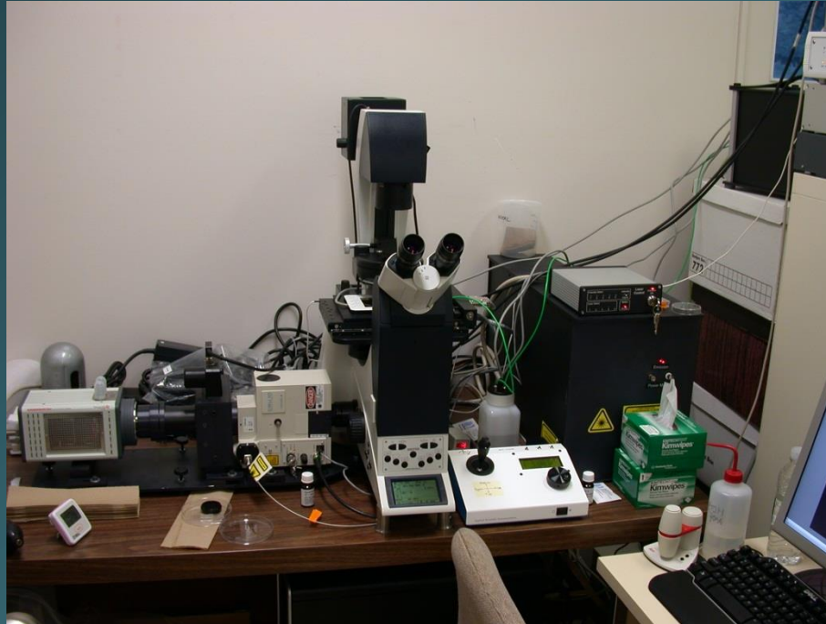
Microscope confocal à disque rotatif (spinning disk) Wave FX de Quorum technologies
